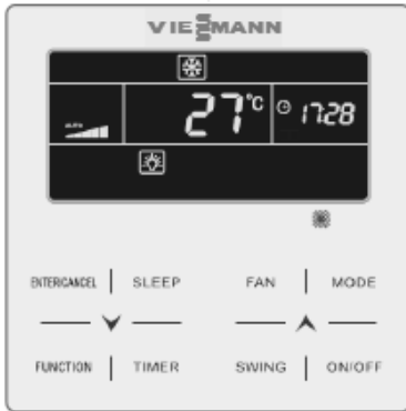
Cihaz ON konumda ve zamanlayıcı ayarlanmış değil
