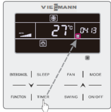
TIMER tuşuna basarak cihazın açma zamanını ayarlayınız.
